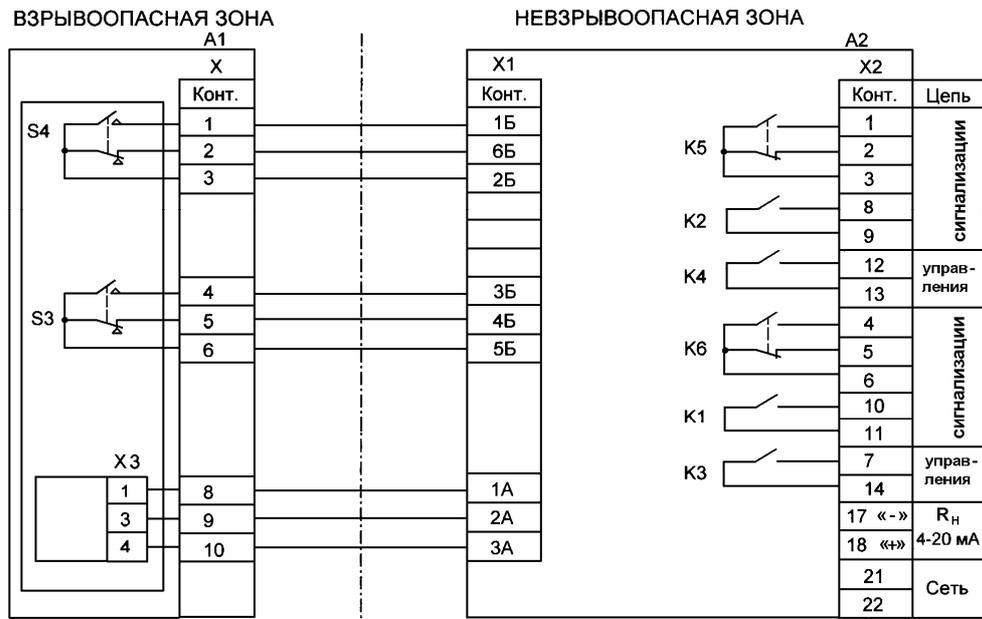
A1 – электрический исполнительный механизм
