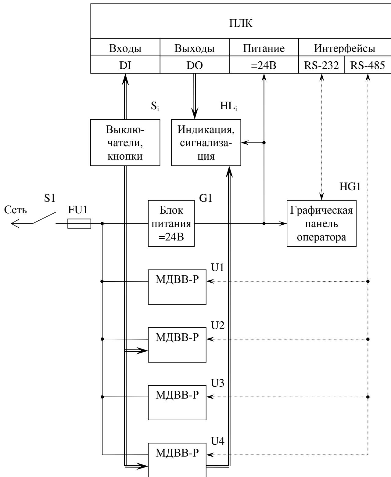
Рисунок 1 - Структурная схема блока управления котлом БУК10-5
