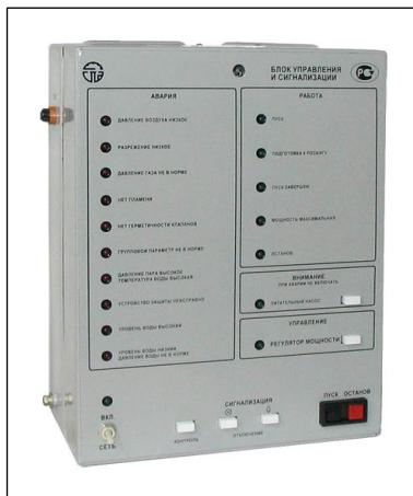
Блок управления и сигнализации БУС12 (в дальнейшем – блок) предназначен для автоматического управления тепловой установкой, работающей на газообразном топливе: паровым или водогрейным котлом малой мощности (до 3,0 МВт), горелками хлебопекарных, обжиговых печей, сушильных камер, агрегатов приготовления витаминной муки, теплогенераторов, устройствами розжига горелок установок средней мощности. Возможно применение блока для автоматизации тепловой установки, работающей на жидком топливе.
