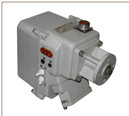
Механизм сигнализации положения МСП-94-УД (далее – механизм) предназначен для сигнализации положения регулирующих органов технологического оборудования и арматуры с встроенным приводом, дистанционного (автоматического) и местного (ручного) реверсивного управления приводом.
